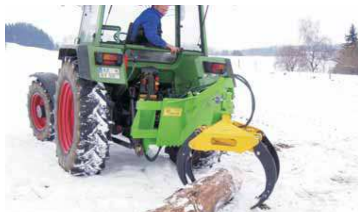
Travaux de débardage avec montage arrière
