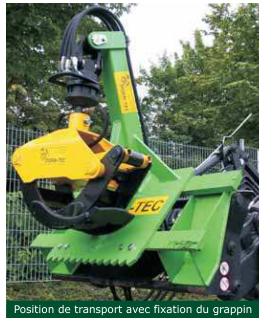
En option avec tête tournante mécanique
