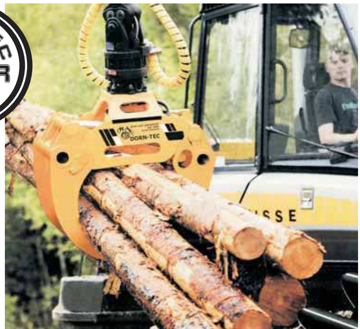
PowerGrip 425 montage sur un porteur
