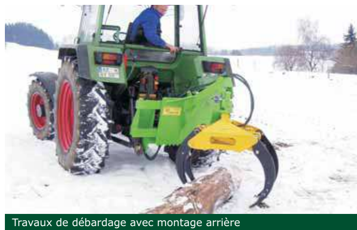
Large débattement avec fixation 3-points intégré
