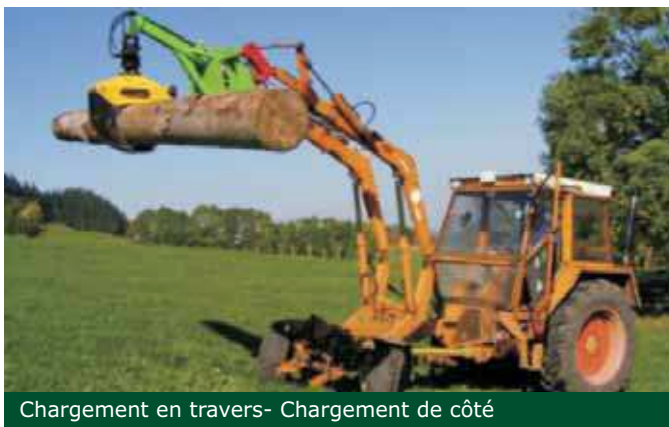
Grappin sur chargeur frontal TopGrip de fabrication allemande
